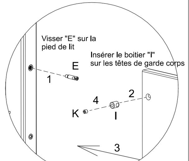
Insérer les têtes de garde corps sur le pied de lit et fixer le tout à l'aide de la vis "K"
